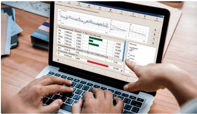
Vista «Evaluación». Resultado con perfil, curva ADK, curva Mr y supervisión de tolerancias
